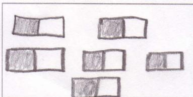
Durch das Magnetisieren werden die Pole fast gleich ausgerichtet.
