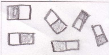
Werden die Teile erhitzt, wirbeln die Elementarmagnete herum. So gibt es keinen Nordpol und Südpol.
